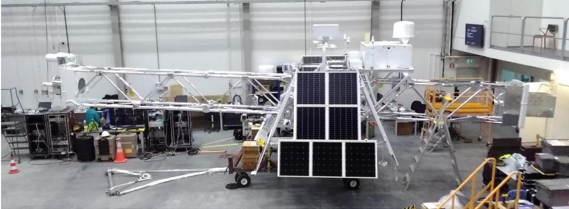
図 1：XL-Calibur 気球の全体写真。2022 年 7 月にスウェーデンから放球し、カナダまで 6 日間のフライトを実施した。全長~12m。左：硬 X 線望遠鏡、右：偏光計。今後も 2024 年の北極圏フライトや南極フライトを計画している。
