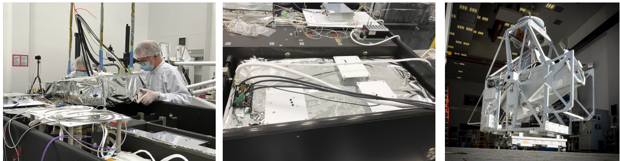
図 5: (左)光学ユニットを焦点面装置箱への組み込み作業、(中) 組み込まれた SCP 光学ユニット。(右)望遠鏡とゴンドラを結合し行った太陽指向試験。
