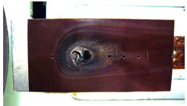
図 10 実験後の模型における焼けた跡
