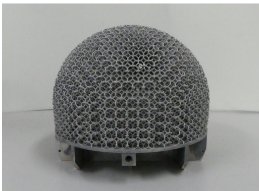
図1 主脚用衝撃吸収材のポーラス金属部。
