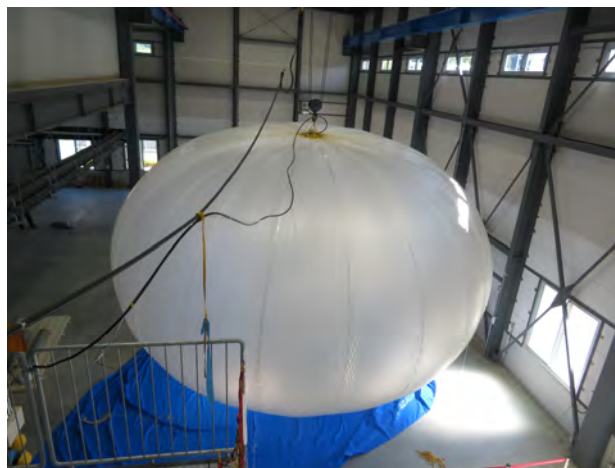
(b) He ガスによる膨張試験時の NPB02-1 気球
