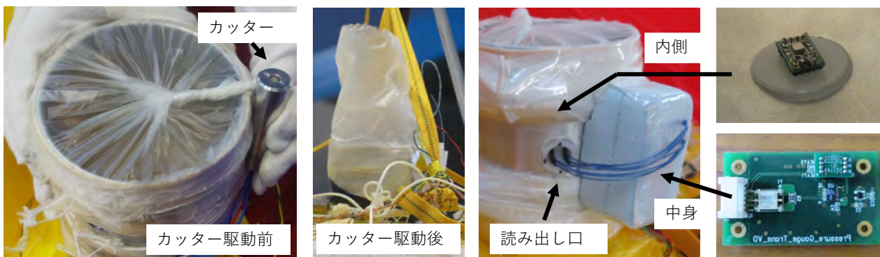
(c) 排気口 (駆動前)、(d) 排気中の排気口、(e) 気圧計測ポートと伝送基板、(f) 気圧計 (上)、(g) 伝送基板 (下)
