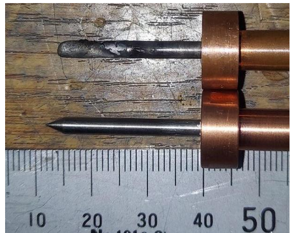
図 3-7 実験前のカソードと水素での噴射後のカソード。
