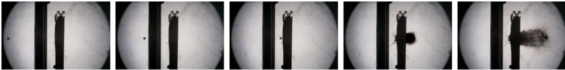
Fig. 3 (上段) 実験セットアップの概略図。弾丸衝突の過程は2台の高速カメラで撮影し、衝突前後の速度差から吸収エネルギーを見積もった。(下段) 横方向から撮影した衝突過程の連続写真。
