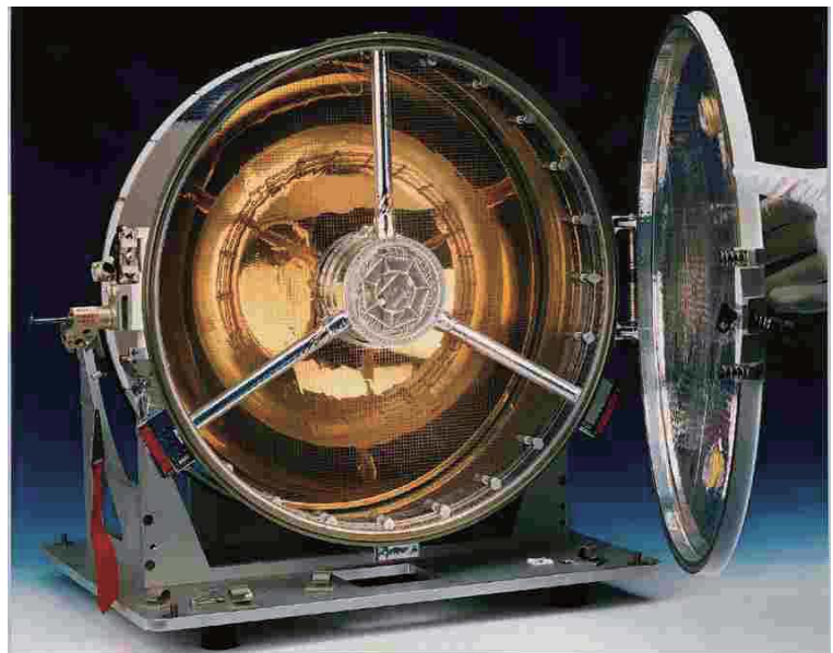
Geostationary Orbit Impact Detector (GORID) 計測面積：0.1 m 2 . (計測エリアの直径は43 cm)
