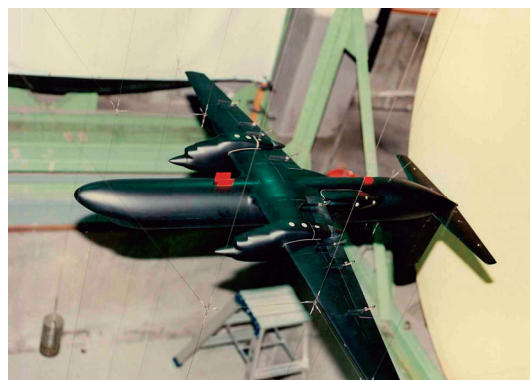
図 1 ワイヤバランス方式による YS-11 全機模型風試
