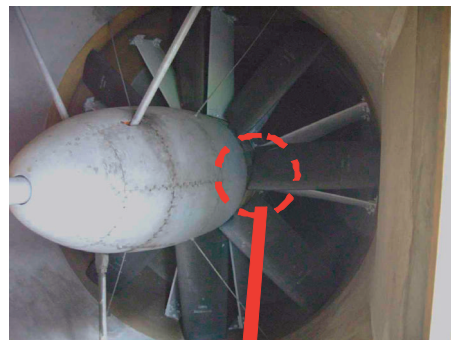
図3 ファン・ブレード固定方式
