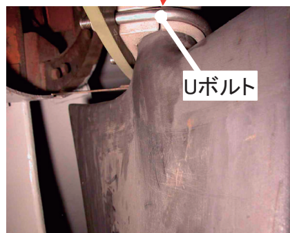
図4 ブレード取り付け部
