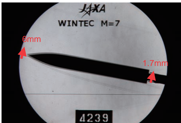
図 3. 迎角 10deg 保持通風中における模型姿勢角の変化。模型先端部で約 6mm 程度反り上がっている。
