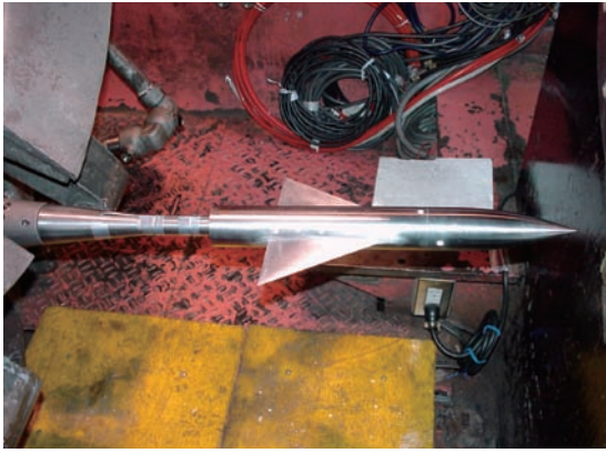
図 1. AGARD-B 標準模型 (HWT1)
