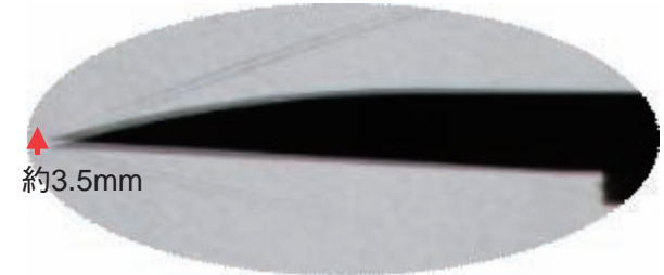
図 16. フロースルーナセル形態における模型変形の有無（迎角変角開始直前および終了直後に取得した画像を重ねている）。模型先端部において約 3.5mm 程度反り上がっていることが分かる。
