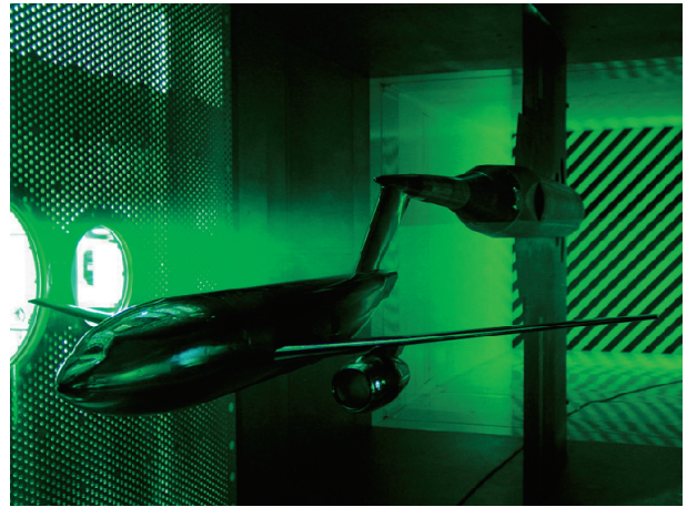
図9 DLR F6 90%スケール模型設置
