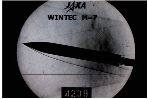
図 4. \alpha=10\text{deg} において発生しているノズル出口からの斜め衝撃波
