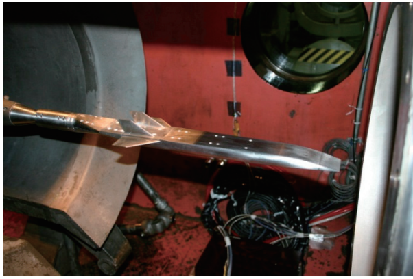
図 13. 極超音速機 M=7 風試状況
