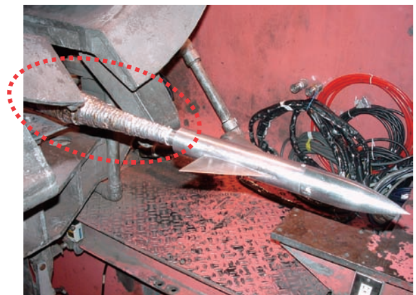
図 6. スティング・スティングポッドにおける断熱処置
