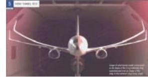
風洞試験における主翼変形例
