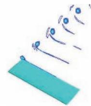
ローターブレード後流渦計算例
