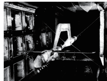
支持干渉風洞試験例 (出展: NASA TN D-4021)
