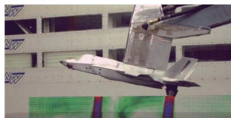
PIV法によるジェット計測例 (出展: EWAニュースレターより)
