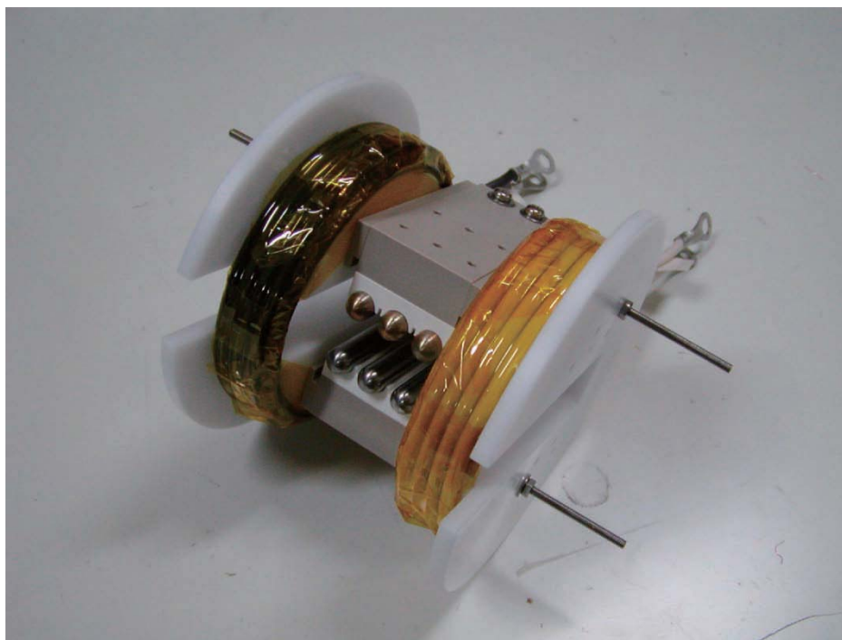
図4 直交外部磁場印加2次元MPD実機写真 (9ターン Helmholtz コイル実装時)
