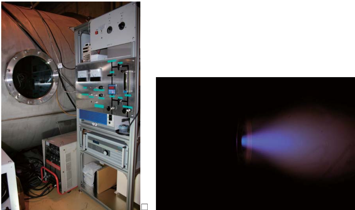
図2 実験装置. 左;真空チャンバーと操作パネル, 右;排気プルーム(推進剤;アルゴン)
