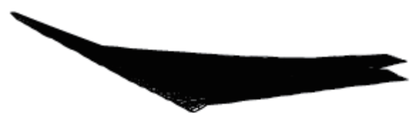
図6 フラッタ解析結果の例 上: 等価大気速度と減衰率の関係 下: 振動モード(1次曲げ)
