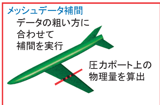
図 4 CFD データに基づく物理量の補間処理概念図
