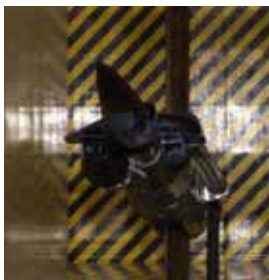
インテーク・機体統合風洞試験
