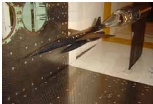
全機高速風洞試験
