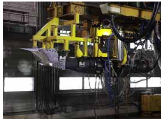
インテーク・エンジン結合形態試験 (地上始動性確認試験)
