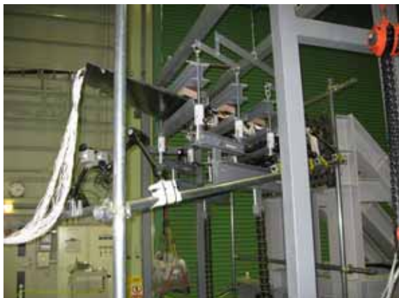
図9 複合材構造研究機試作主翼の強度試験
