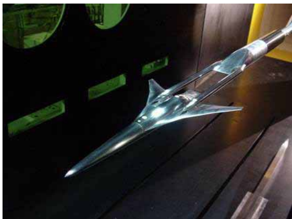
図8 双スティング支持による後端低ブーム設計検証風試
