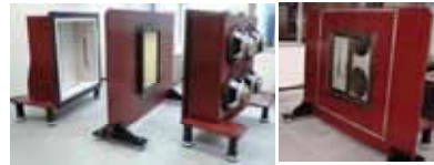
ソニックブーム音響・構造振動試験装置の開発 (左:全体図、右:窓サッシ試験体)
