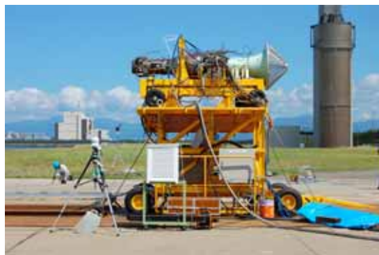
図10 低騒音ノズルのエンジン試験
