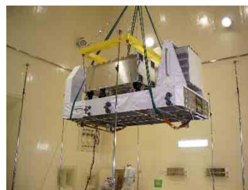
曝露パレット(EM)単体音響試験
