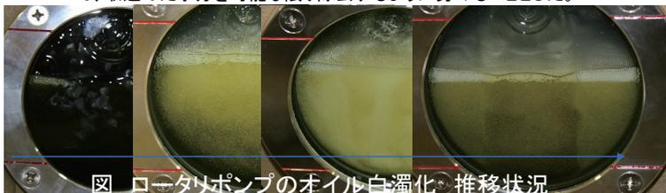
図 ロータリポンプのオイル白濁化 推移状況
