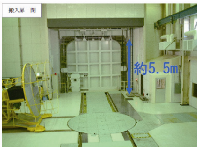
8mφスペースチャンバ (縦置き円筒型)
