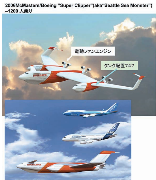
図18 Boeingにおける超大型水素燃料電動ファン航空機検討例 ([49])
