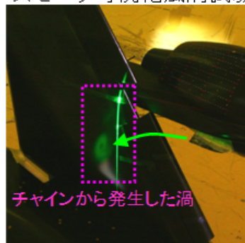
図1 高揚力装置のナセルチャインによる性能向上メカニズム調査
