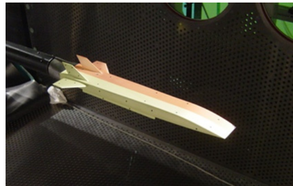
図 7 TWT1 用塗装：PSP/TSP 塗り分け
