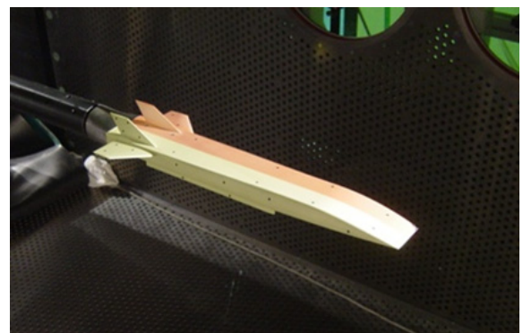
図 7 TWT1 用塗装：PSP/TSP 塗り分け
