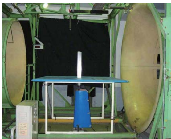
図3 ブレード単体風洞試験
