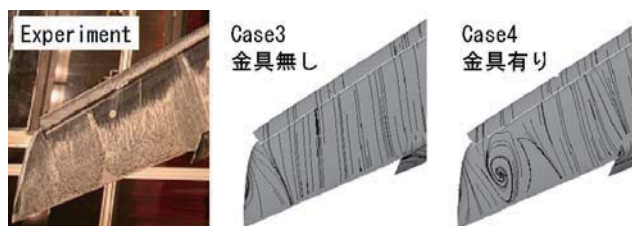
図11 迎角10度における翼端のオイルフロー可視化結果 スラット金具有無の比較
