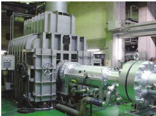
図 1.2 0.5m 極超音速風洞
