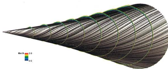
図2 逆フレア型軸対称形状の Oil flow および境界層厚さ( M=2, \alpha=3^\circ )
