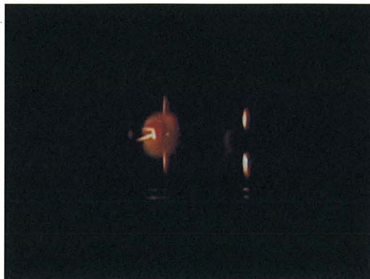
図2 微小重力実験結果 第2液滴着火 (第1液滴着火から0.574秒後)
