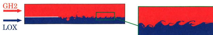
図 1 ロケットエンジン噴射器流れに関する超臨界水素・液体酸素二相流解析。
