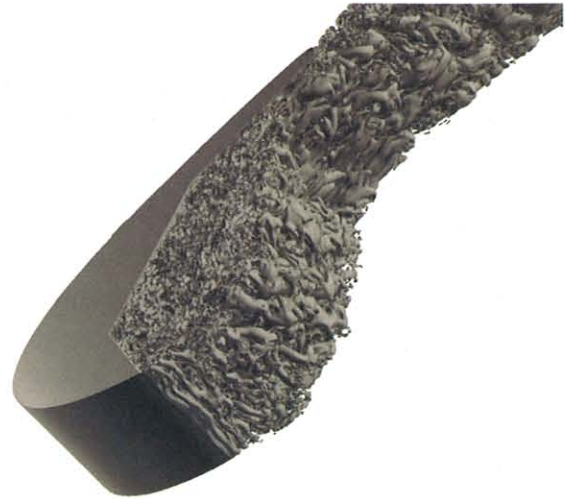
図2 NACA0012 翼端周りの非定常解析結果 (渦度の等値面)
