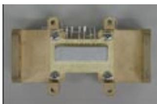
Fig. 2.3.2-3 LNA Module for 36GHz Receiver
