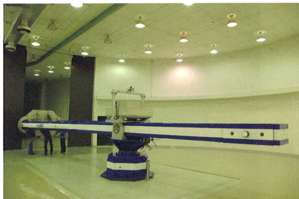
Fig.7 旋回腕試験装置
