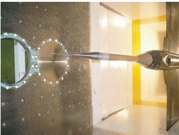
図4: 静圧プローブ設置状況
