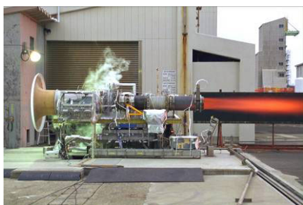
図 3.1-3 ATREX 燃焼実験
