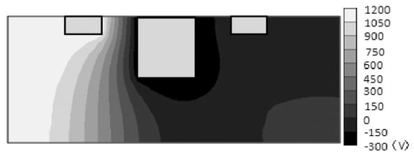
図6 電位分布 (中性粒子：拡散反射)
