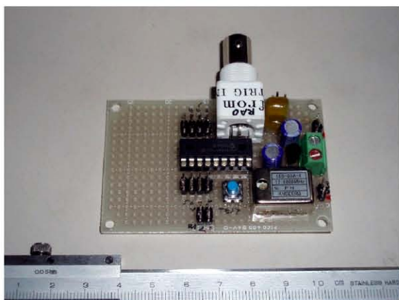
図2 PtOEP を用いた燐光寿命測定に機能を特化した小型トリガボード。励起信号とシャッタートリガ信号は、それぞれワンチップマイコン (PIC16F84A) によって生成される。
