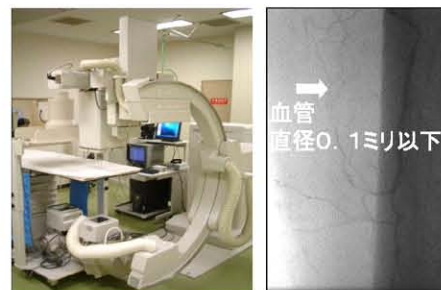
図 17 微小血管 X 線撮影装置と微小血管画像 (国立循環器病センター)
