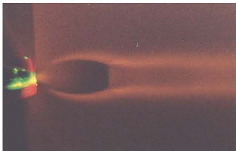
図 2 I 2 -LIF による超音速自由噴流の可視化
