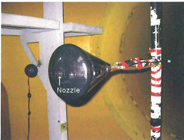
Fig. 2 6分力計測及び表面圧力計測に用いられた風洞模型 (RVTの1/12スケール)
