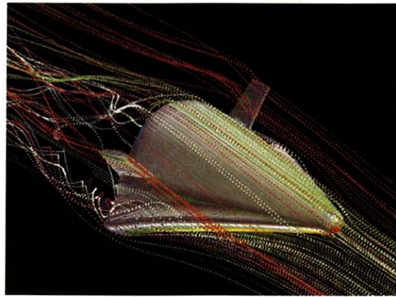
Fig.3 三次元流線図 ( M_\infty=0.3 , \alpha=15^\circ , ストレーク部における前縁剥離渦の発生からみられる)
