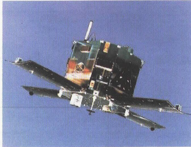
図11 科学衛星“あけぼの”と太陽電池パドルの先端に取り付けられた円板状プローブ。
