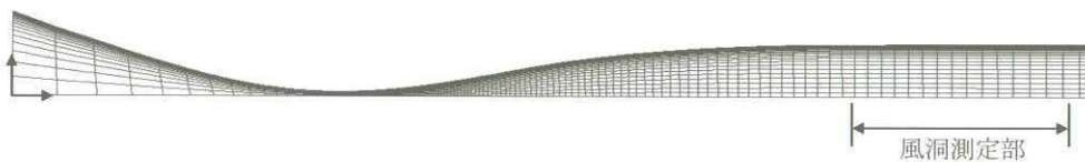
図2 超音速風洞 CFD 解析格子 (測定部マッハ数 4.0)
