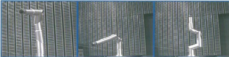
写真 19 多関節ロボット [提供:JAXA 総合技術研究本部宇宙先進技術研究グループ中島研究室]
