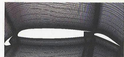
図 3 Full-span flap モデル周りの Fine マルチブロック構造格子の 50%スパン位置における計算格子
