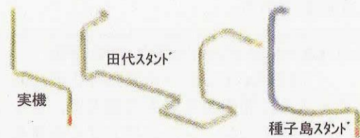
図9. LE-7A エンジン LOX フィードライン CFD 解析 (左から実機、田代、種子島スタンドにおける流線)
