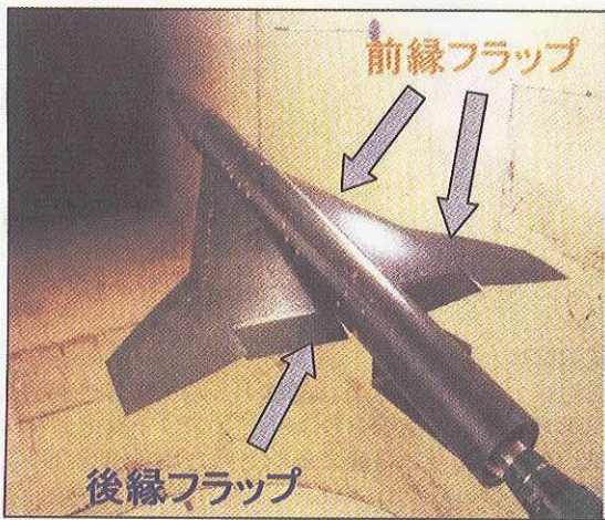
図 3. JAXA の 2 m×2 m 低速風洞試験の様子
