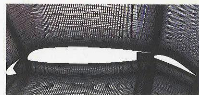
図 3 Full-span flap モデル周りの Fine マルチブロック構造格子の 50%スパン位置における計算格子
