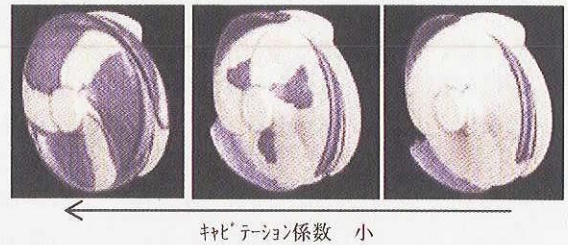
図10. LE-7A OTP 改良設計インデューサの CFD 解析 (キャピテーション係数の減少に伴うキャピテーションの変化) (青色:キャピテーション発生領域)
