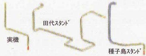
図9. LE-7A エンジン LOX フィードライン CFD 解析 (左から実機、田代、種子島スタンドにおける流れ)
