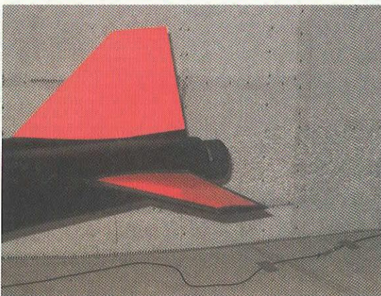
図 8. 無響風洞内でのエンジンテスト
