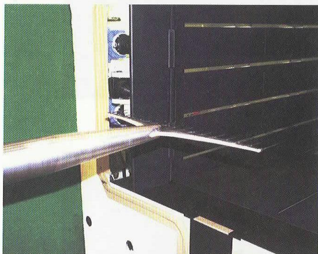
図5 試験状態写真(計測部断面マッハ数分布試験)
