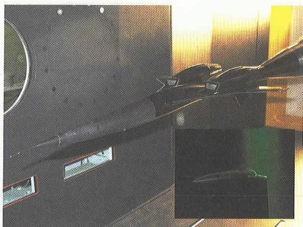
図 7 SST ジェット実験機圧力模型
