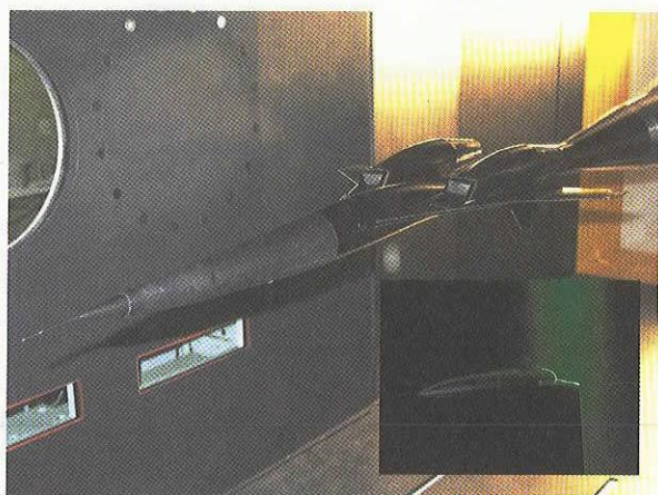
図7 SST ジェット実験機圧力模型
