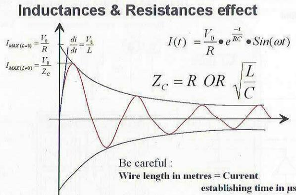
**Figure 9** : Discharging circuit oscillations
